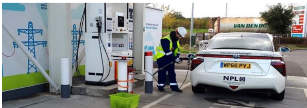
Figura 3.12. Recarga de un coche de hidrógeno en una HSR. Fuente: https://www.sintef.no/projectweb/metrohyve-2/
