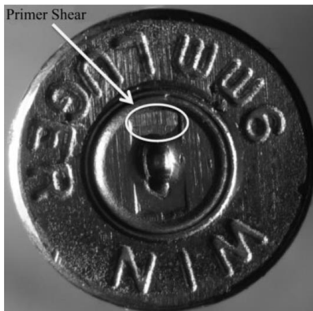
Figura 3.21. Patrón estriado producido por la acción de cizalla de la recámara de la Glock 19 contra el cartucho.
