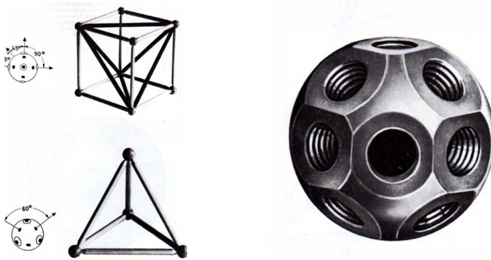
Figura 74. Módulo de Nudo y construcciones
