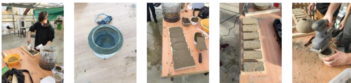
Figura 47. Llenado de probetas y pulido
