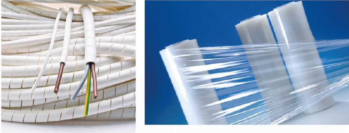
Figura 30. Aplicaciones de LDPE: cables aislantes, films resistentes y flexibles. material de embalaje, envases de plástico blando, cuencos, tapas, juguetes, recipientes, films, botellas exprimibles, bolsas, sábanas.
