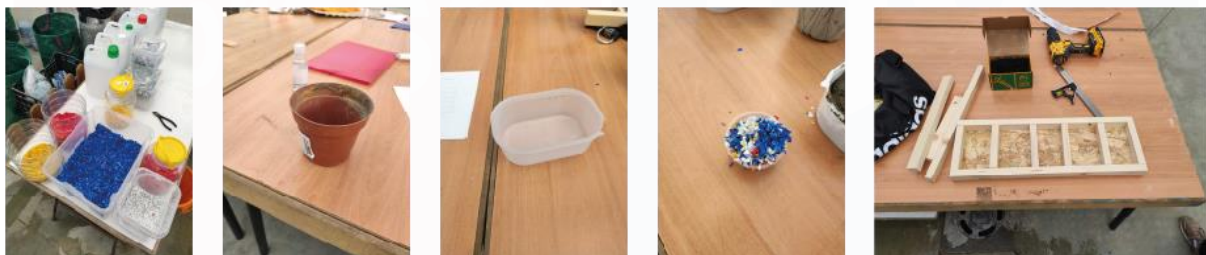
Figura 45. Material necesario, de izquierda a derecha: cubos con plásticos de color, medida de áridos, envase de mezclas para probetas, medida de plástico, molde de probetas.
