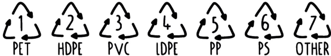
Figura 25. Código de identificación de resina
