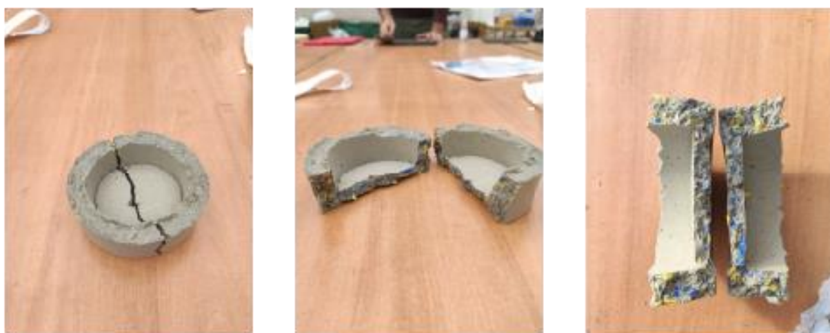
Figura 48. Rotura de molde
