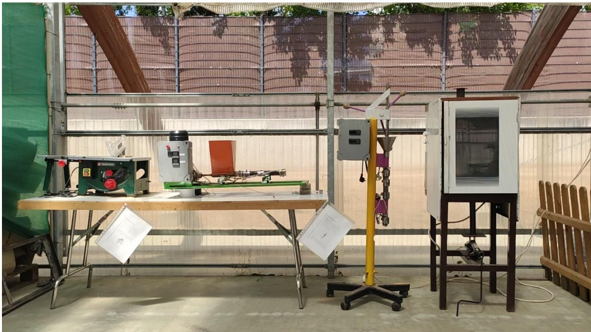
Figura 17. Zona de Moldeo: Máquinas de procesado, de dr a iz: Compresión, inyección, extrusora y sierra circular de mesa (para cortar las planchas del material)
