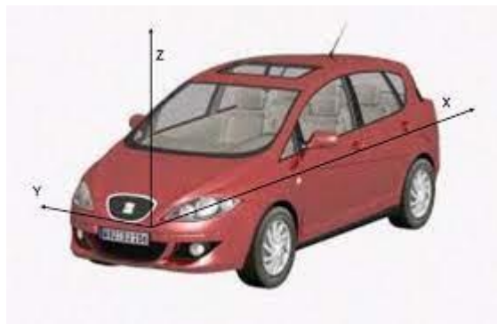
Imagen 2.7. Ejes de coordenadas utilizados en automoción.
