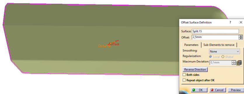
Imagen 3.7. Superficie B de la pieza mediante la función offset.
