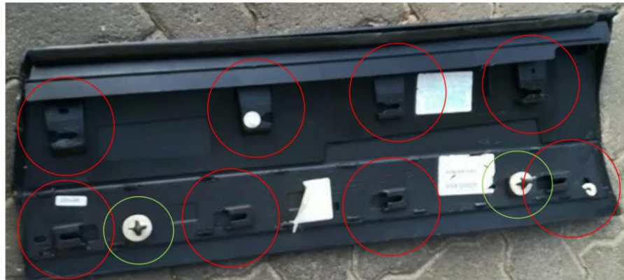
Imagen 3.36. Ejemplo de fijaciones en el embellecedor del Citroën C4.
