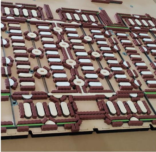
Fig. 104. Troquel plano y sus componentes
