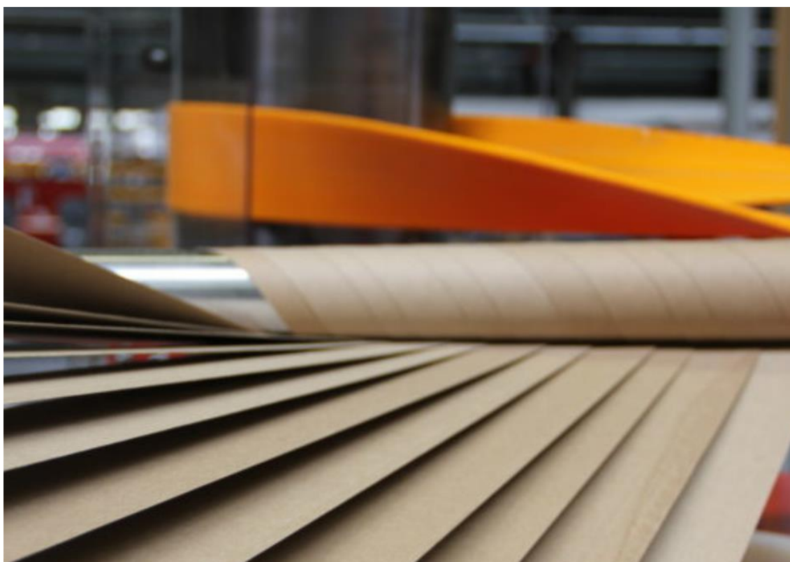
Fig. 108. Entrada de papel en el mandril y cinta de goma
