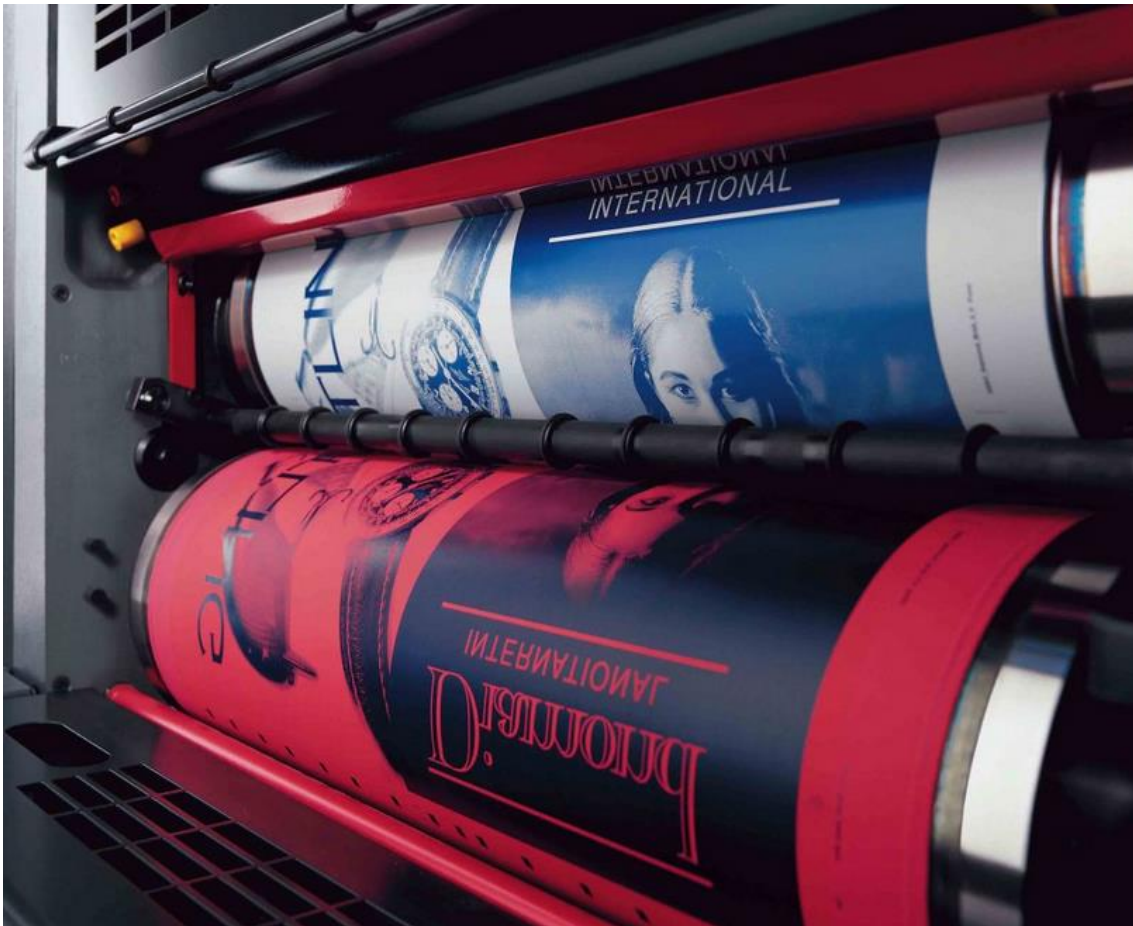
Fig. 101. Detalle de un cilindro offset
