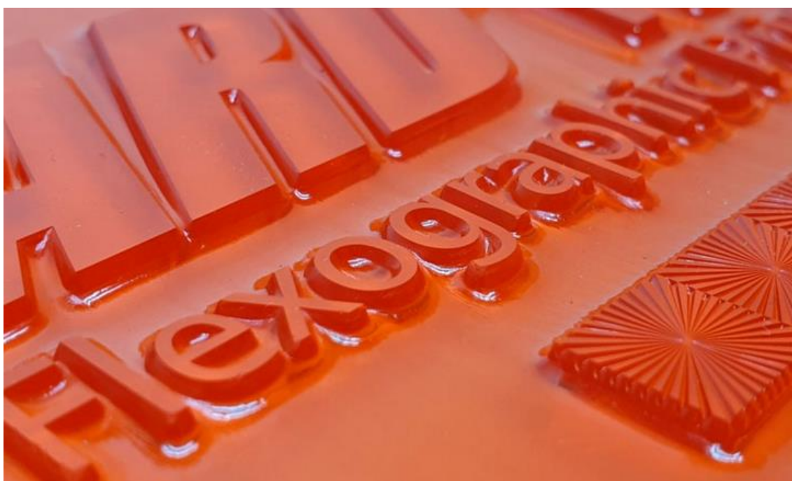
Fig. 98. Detalle de un cliché flexográfico
