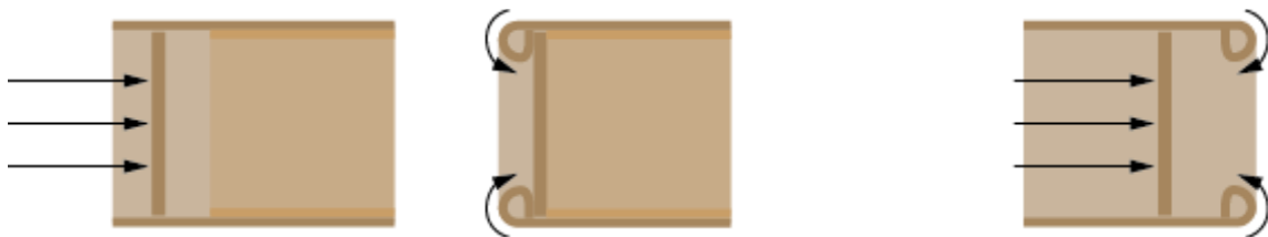
Fig. 112, fig. 113 y fig. 114. Montaje de disco y plegado de borde en cuerpo (izq. y centro) y en tapa (dch.)
