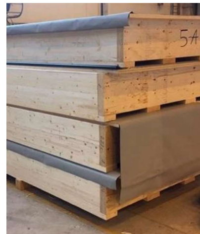
Fig. 70. Fotografía del forjado en taller de la Torre Mjøstårnet, Noruega. Fuente: https://cutt.ly/fmyKyuc
