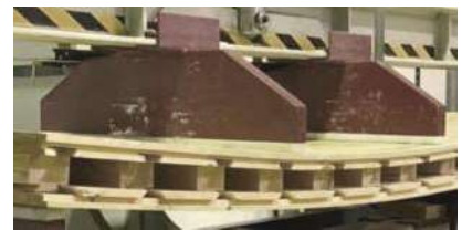
Fig. 81. Prueba experimental del estudio de flexión de los paneles TTP. Fuente: (Baño & Moltini, 2021, p. 4).
