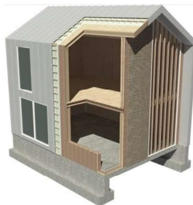
Fig. 79. Infografía del modelo completo en 3D con aplicación de los paneles ETC en estructura horizontal, vertical y cubierta. Fuente: https://www.3edata.es/portfolio/socio-life-ecotimbercell/
