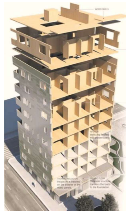
Fig. 90. Fotomontaje en 3D de la estructura del edificio The Stadhaus construido en Londres. Fuente: https://cutt.ly/Hmu9Gf1
