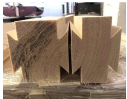
Fig. 82. Fotografía del conector de cola de milano durante el proceso de fabricación del TTP. Fuente: (Baño & Moltini, 2021, p. 3).
