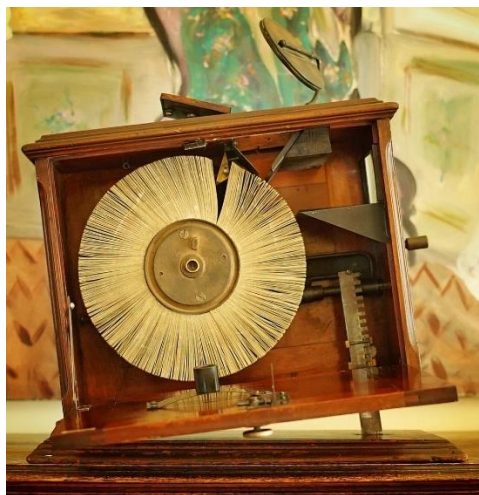
Imagen 4. Interior del mutoscopio. Fuente: Imágenes de Google 16 .
