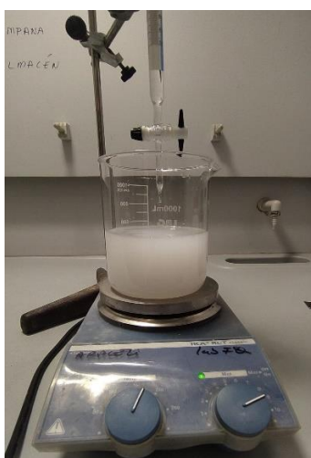
Figura 8. Montaje de la síntesis de fotocatalizadores de ZnO
