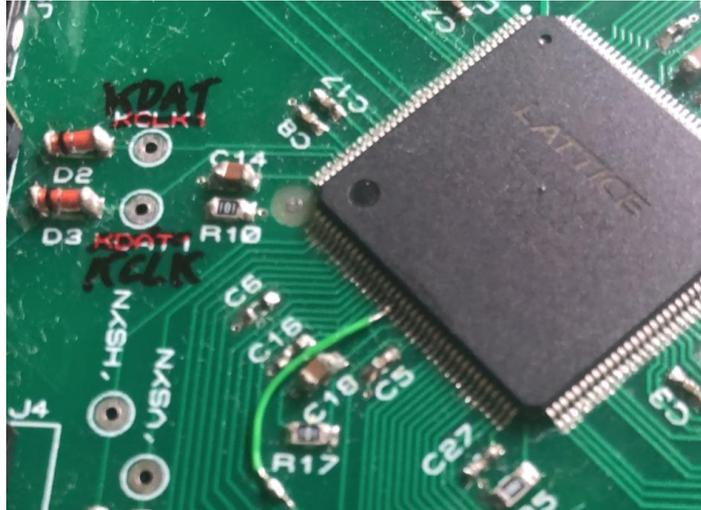
Ilustración 20. Corrección primer error diseño.
