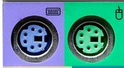
*Ilustración 8. Interfaces PS2 de teclado y ratón.*
