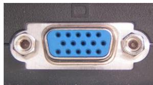
*Ilustración 7. Conector VGA hembra.*
