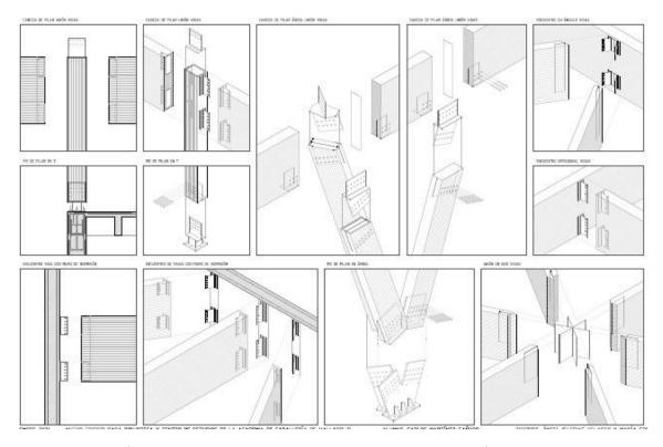
Esquema de unión de estructura de madera a basamento de hormigón.
