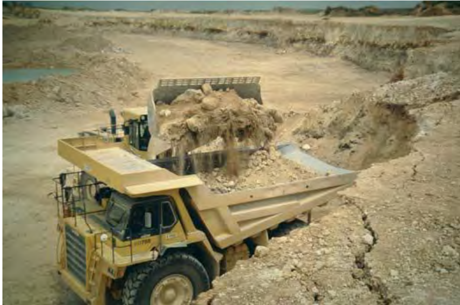
Imagen 5. Carga directa de áridos calizos sobre dumper
