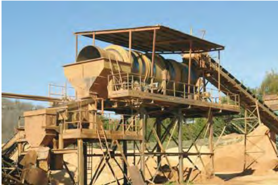
Imagen 9. Trómel lavador de áridos
