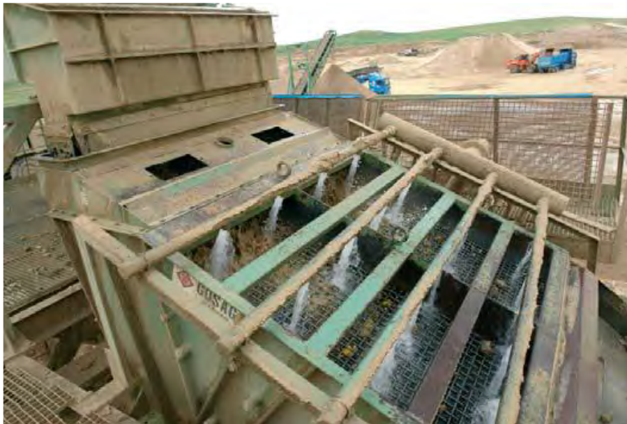
Imagen 8. Detalle de una criba de clasificación de áridos
