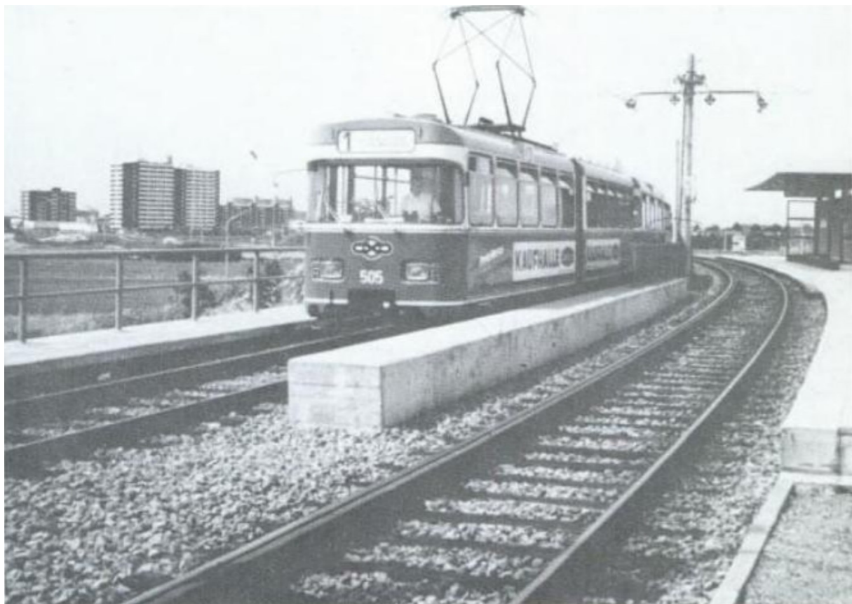
Fig. 124. Plataforma elevada en Bremen para el acceso al tranvía como en el metro. Fuente: Diamant, E. S. (1976), p. 27.
