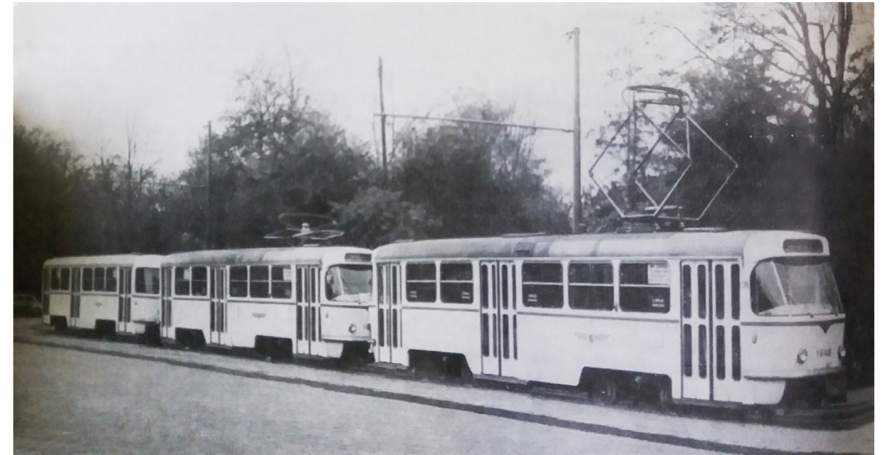
Fig. 129. Combinación de T4D+T4D+B4D en Leipzig. Fuente: Berhge, M., Heiner, M. (1978) Die Straßenbahnen in der DDR. Geschichte Technik Betrieb , Berlin: Motorbuch Verlag, p. 68., fuente original Verkehrsbetriebe Leipzig.
