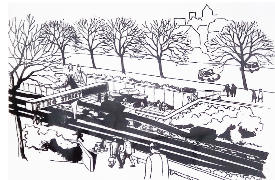
Fig. 195. Unas de las soluciones ultramodernas incluidas en el estudio de Miroslava Lukášika. Las cabinas ferroviarias rápidas para el uso individual con una velocidad hasta de 80-115 km/h. Fuente: Lukášika, M. (1974) Dopravní Prostředky a Systémy, jejich Vývoj, Inovace , en Zmija, K. (ed.), Studie Přehodnocení Koncepce MHD v Ostravě , Ostrava: Útvár Dopravního Inženýrství Města Ostravy, p. 230. Se puede notar la solución espacial de la parada donde hay una diferenciación de niveles para proveer las condiciones para el desarrollo de velocidades altas. Una solución similar fue aplicada en los proyectos de tranvía independizado en Lišeň y Bohunice en Brno.
