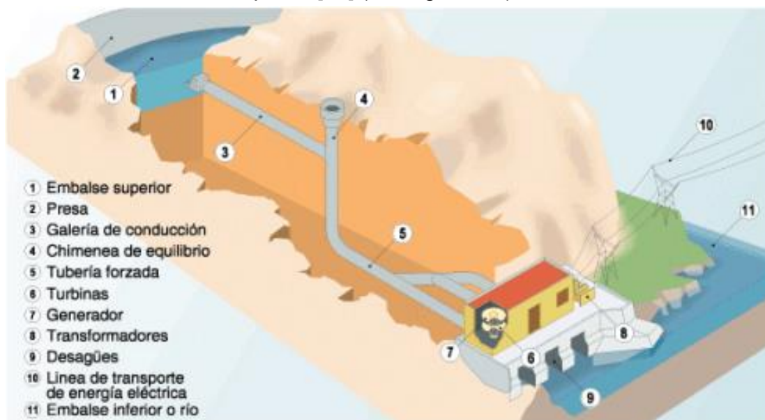
Figura 2.6. Esquema de una central reversible con bombeo mixto [21].
