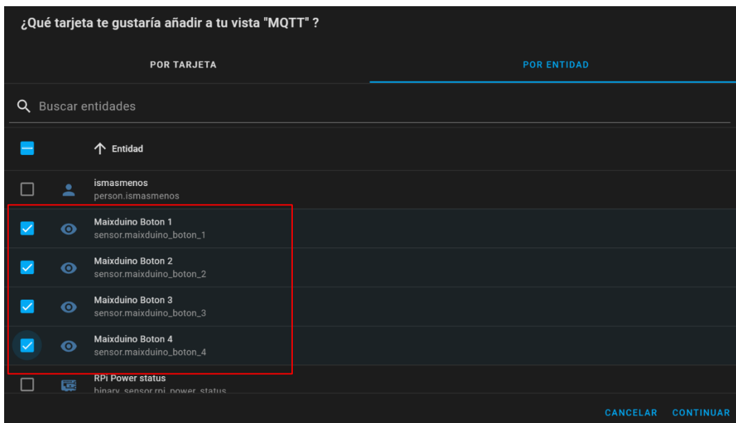
FIGURA 79. Entidades correspondientes a los cuatro botones digitales en el panel MQTT de Home Assistant
