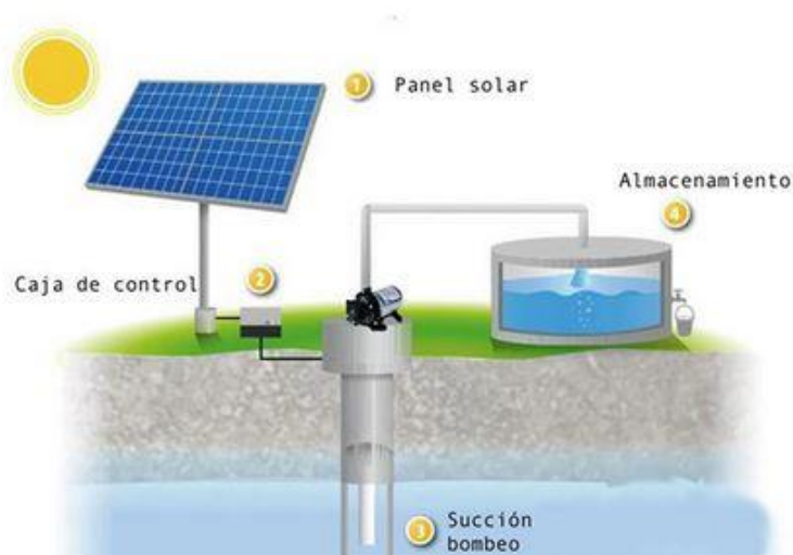
Figura 8 Instalación de bombeo aislado [W4]
