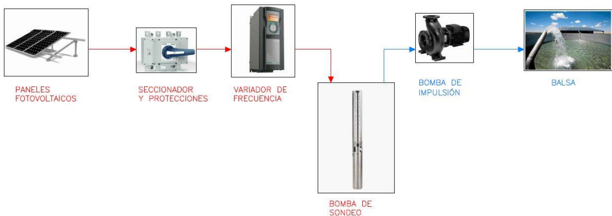
Figura 6 Esquema de bombeo solar directo a balsa
