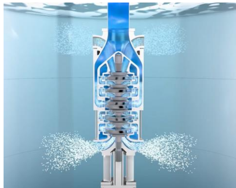
Figura 35 Detalle de bomba sumergible en funcionamiento [W22]
