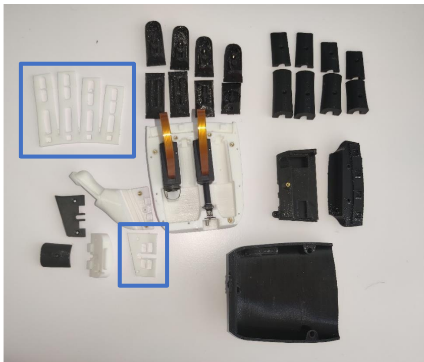
Figura 33. Piezas impresas con impresora 3D, Brunel Hand. Recuadradas en azul se encuentran las piezas impresas con material TPU.
