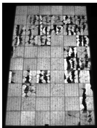
Fig. 1. Ejemplo de una imagen de EL de un panel de Si multicristalino
