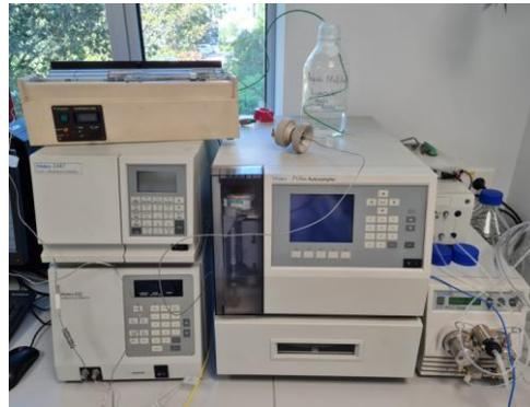
*Figura 22: Cromatógrafo HPLC*
