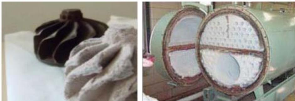
Figura 7: Acumulación de siloxanos en turbinas y calderas (*Origen, Efecto y Tratamiento de Los Siloxanos En El Biogás*, <https://condorchem.com/es/blog/tratamiento-siloxanos-biogas/>)
