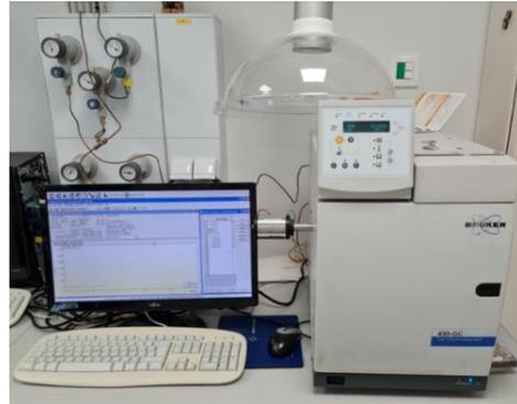
Figura 20: Cromatógrafo GC-TCD
