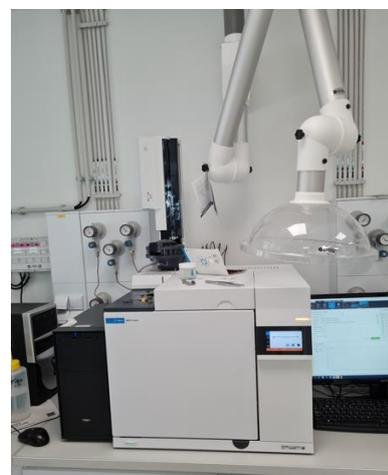
Figura 19: Cromatógrafo GC-FID
