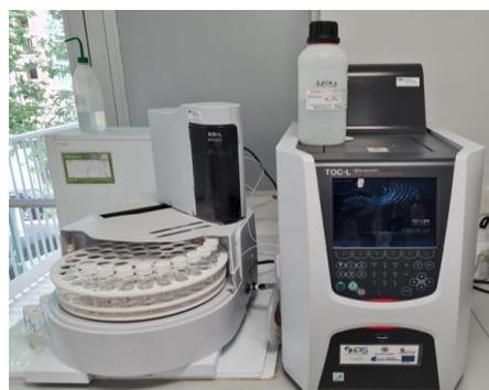
Figura 21: Analizador de TOC, IC y TN
