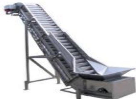
Imagen 10. Elevador de cangilones.
