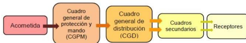
Ilustración 1. Red de instalación eléctrica
