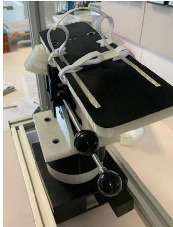
Nota: Se muestra la plataforma de apoyo de la solución anterior, donde se proyecta el eje Y paralelo a la dirección de marcha del pie humana, respecto donde se plantea realizar la rotación de dicha plataforma. Imagen de realización propia
