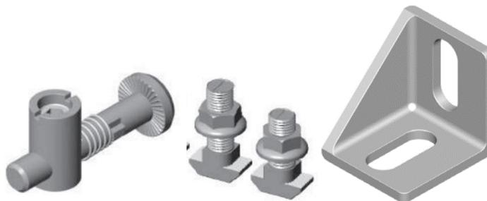
Nota: Se muestran los elementos de unión que harían posible la fijación de la estructura, en este caso pensando en el uso de perfiles de sección 40x40 de FASTEN, a falta de especificar
