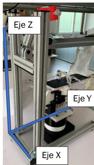
Nota: Se presentan los ejes que se utilizarán durante el desarrollo del diseño (Eje Z vertical, Eje X, Y horizontales), imagen de obtención propia, sobre el diseño referencia mejorado
