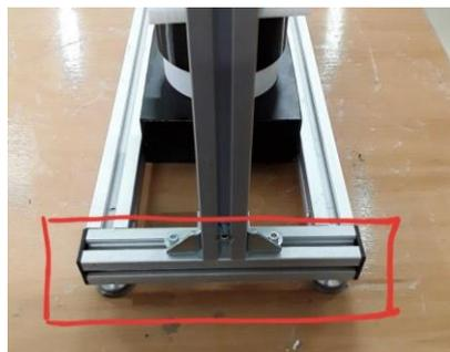
Nota: En la imagen anterior, se muestra en general la realización de una base a través de perfilería y demás componentes, que se encontraban existentes, entre ellos perfiles, tapetas, pies base, tornillería, ...Imagen de obtención propia
