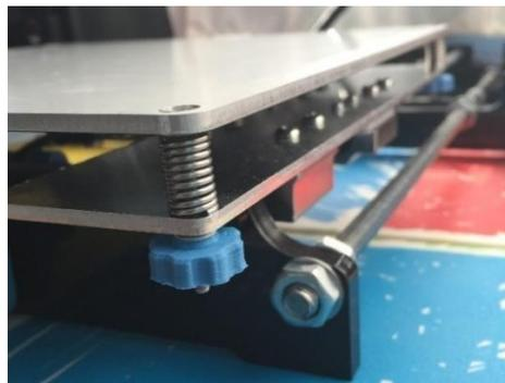
Nota: Se muestra un ejemplo de tornillo fijado a la plataforma que, a través de una tuerca, en este caso la tuerca azul para mejor manipulación se manipula y regula la altura. Imagen obtenida por icuenca.com en uno de sus blogs (icuenca.com, 2017).
