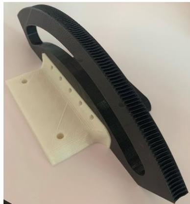
Nota: En la ilustración anterior se muestra las piezas cambiadas dentro del diseño para adaptarse al proceso de fabricación. Este cambio, se puede observar en la rueda helicoidal X, Y. Imagen de obtención propia, a través de la impresión 3D de dichas piezas.
