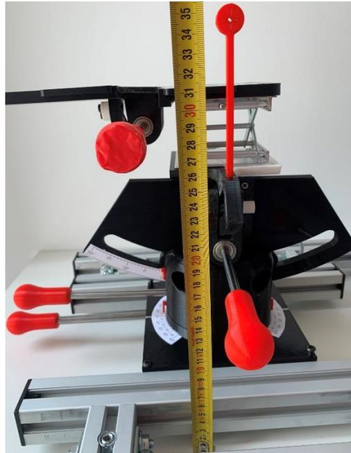
Nota: Se muestra la altura máxima del producto, suponiendo una altura de tobillo mínima de 45 mm. Obteniendo una altura acorde a la especificada. Imagen de obtención propia.
