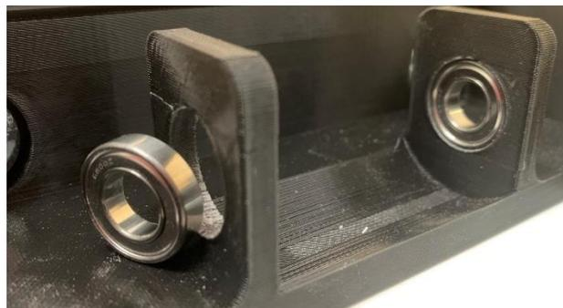
Nota: Se muestra en la imagen la pieza base impresa, donde se ha realizado mecanizado de dichos agujeros para encajar por presión los rodamientos del eje Z. En este caso se vio un problema inicial al obtener un agujero muy pequeño y rasgar la pieza donde encajarla.
