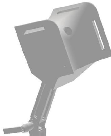
Nota: En la ilustración anterior se muestra la sujeción simultánea de pantorrilla y muslo, en la parte superior se sujetará el muslo, en la parte lateral se sujetará la pantorrilla. Esta imagen es de obtención propia debido al desarrollo CAD.
