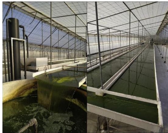
Ilustración 3. Reactor cascada Thin-Layer en la Estación Experimental IFAPA (Almería, España) (Fuente: [7])
