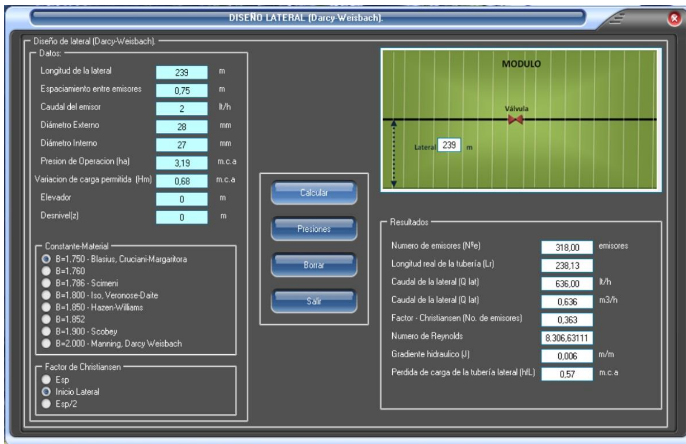
Ilustración 1: resultados de cálculo de tuberías laterales. Fuente: Aqua.
