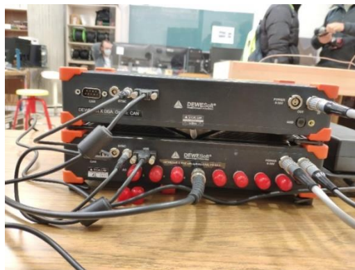
Figura 10. Conexiones delanteras del SIRIUS HD-STG
