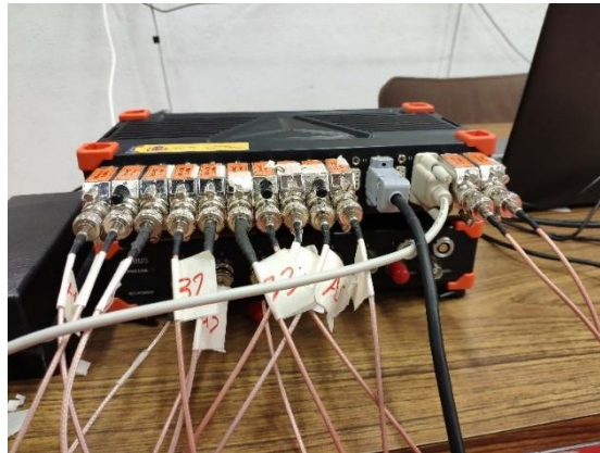
Figura 9. Conexiones traseras del SIRIUS HD-STG
