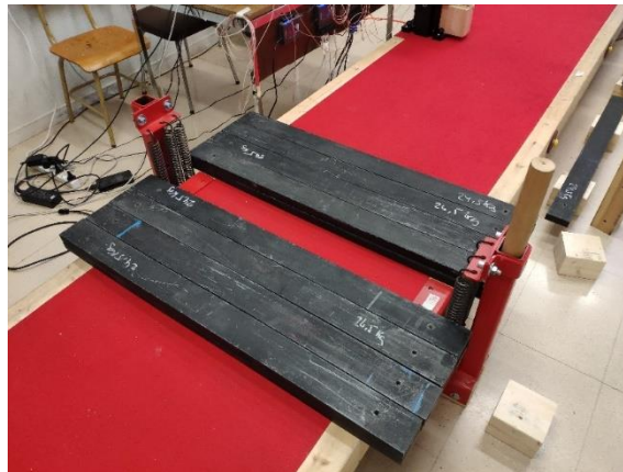
Figura 30. Disposición de listones equivalentes a 392 kg en la sección central de la plataforma
