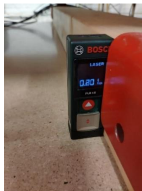
Figura 28. Distancia de referencia inicial medida por el telémetro
