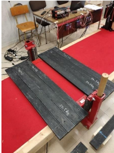
Figura 29. Disposición de listones equivalentes a 196 kg en la sección central de la plataforma
