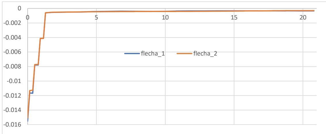
Figura 68. Evolución de la flecha durante el proceso de descarga
