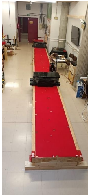
Figura 60. Cargas colocadas para la prueba de carga con la plataforma triapoyada
