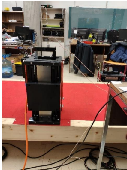
Figura 24. Disposición excéntrica del shaker en la plataforma
