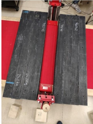
Figura 23. Disposición de las cargas en la sección central durante el ensayo estático
