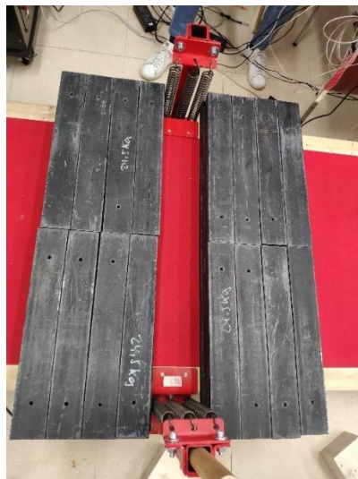
Figura 32. Disposición de listones equivalentes a 784 kg en la sección central de la plataforma
