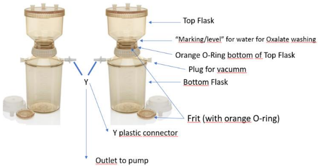
Figura 10. Sistema de filtrado.
