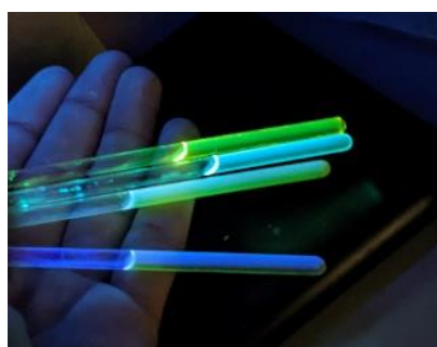
Figura 72: Comparación de la emisión de los compuestos obtenidos en tubos de RMN. Arriba, la emisión debida al complejo 7b , abajo, la emisión debida al ligando libre. En el tercer tubo se puede apreciar la emisión debida al mismo complejo 8 .
