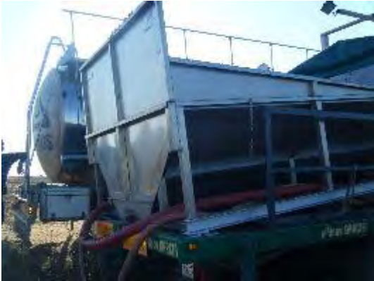
Ilustración 3. Tolva de recepción de vendimia
