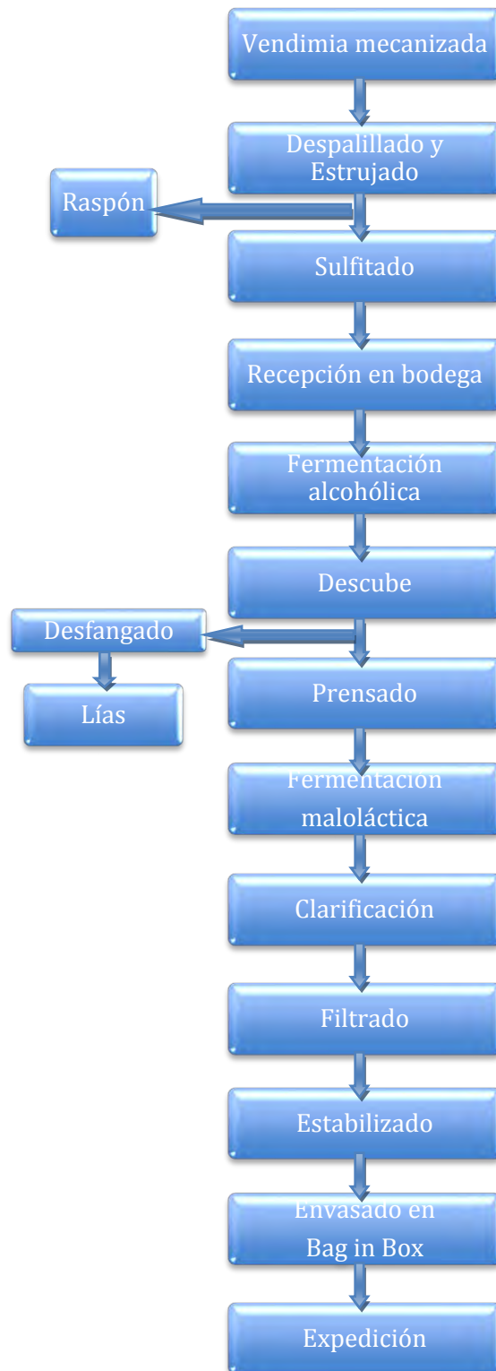
Ilustración 6. Diagrama de elaboración del vino
