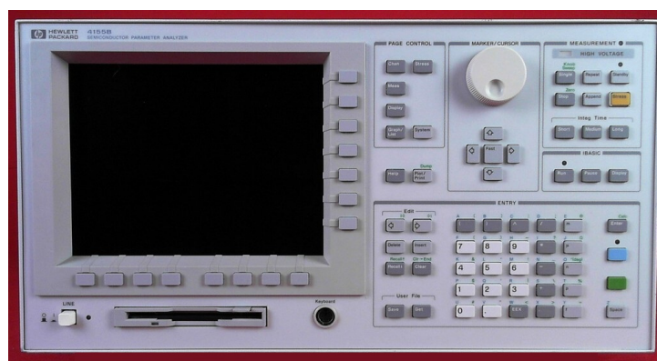
Figura 3.5: Equipo Hewlett Packard 4155B Semiconductor Parameter Analyzer utilizado en la caracterización.
