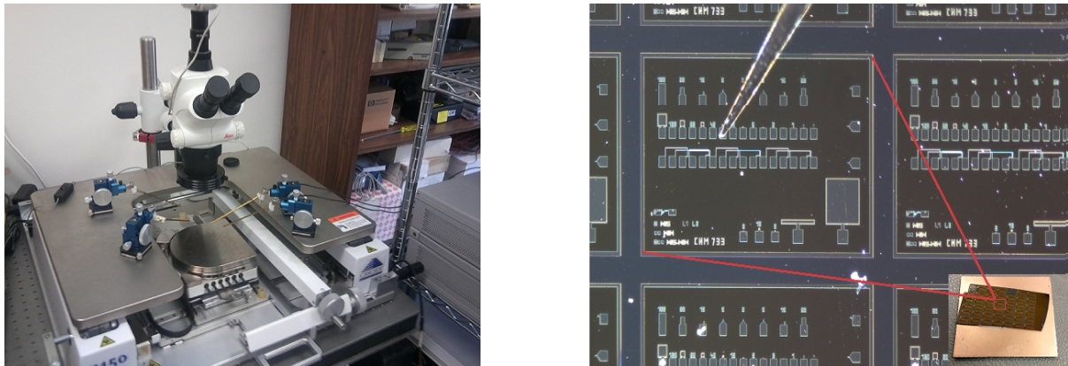
Figura 3.4: La primera imagen ilustra la mesa de puntas donde se lleva a cabo la caracterización. El microscopio permite la correcta disposición de las puntas sobre los electrodos de la muestra, que se sitúa en la placa inferior. La segunda se corresponde con la visualización bajo microscopio de la máscara de una muestra MIS . Se puede observar una de las puntas de tungsteno sobre un TE .
