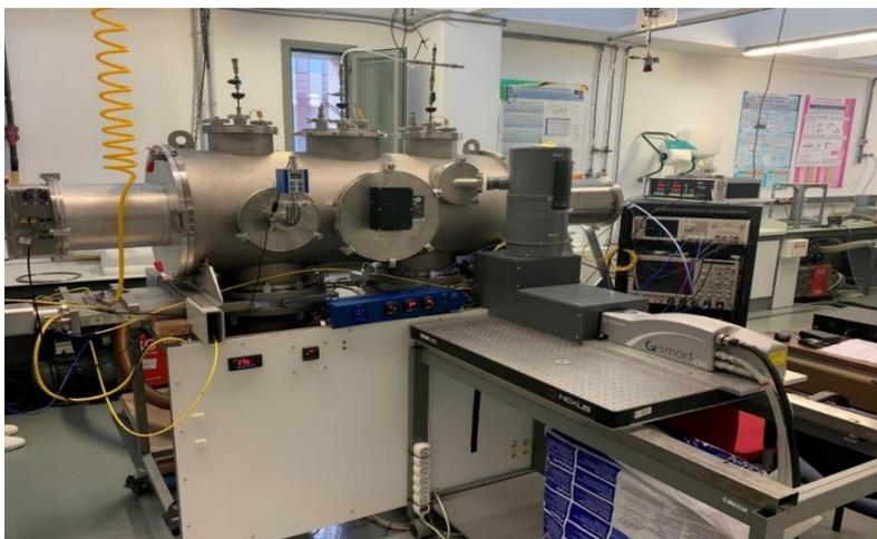
Figura 7. Espectrómetro de microondas de banda ancha CP-FTMW (Chirped Pulse Fourier Transform microwave spectroscopy)
