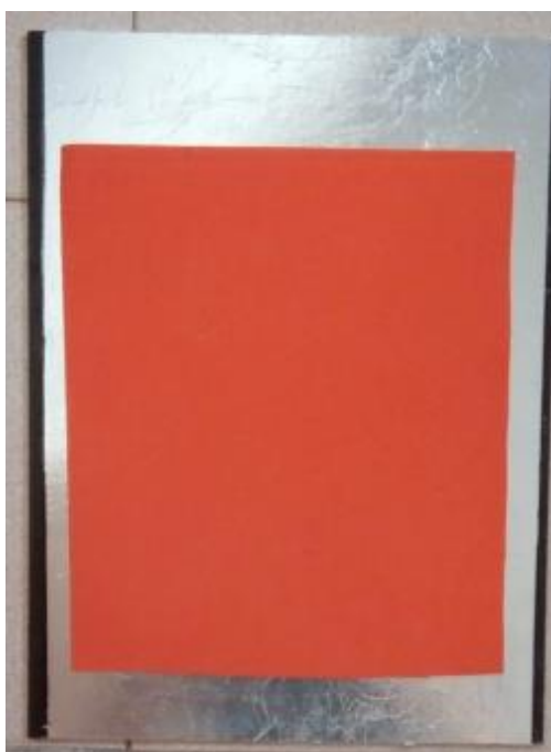
Imagen 32: colocación del dieléctrico.
