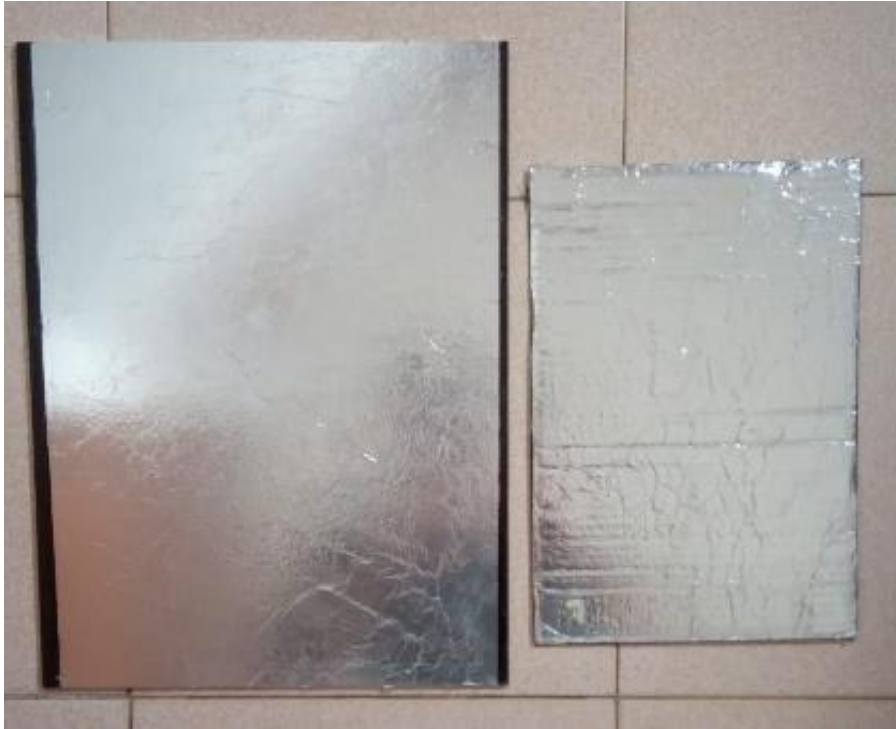
Imagen 30: caras externas de condensadores con soportes de chapón (izquierda) y cartón (derecha).
