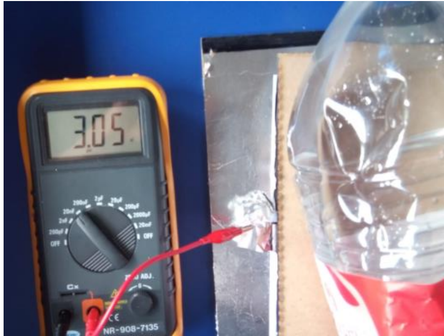
Imagen 42: medida de la capacidad de dos condensadores de una única capa de dieléctrico (papel) conectados en serie.
