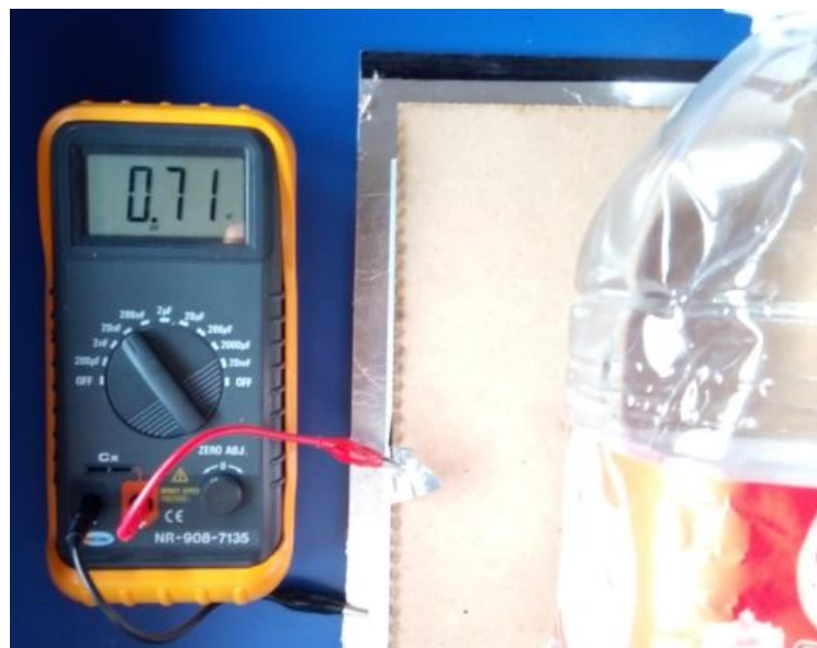
Imagen 40: medida de la capacidad del condensador en serie.
