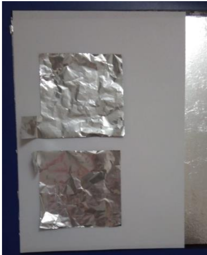
Imagen 41: montaje experimental de dos condensadores en paralelo.
