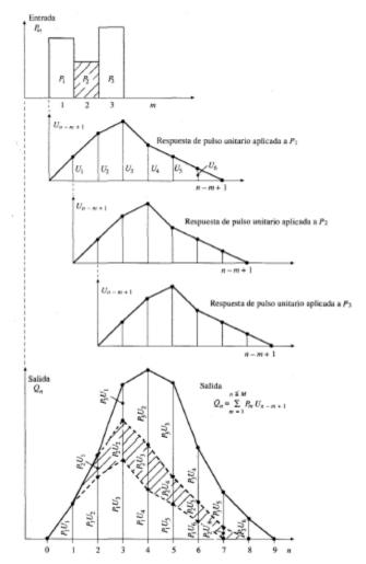
Figura 45. Esquema de convolución y generación de un hidrograma final. Fuente: CHOW (1994).
