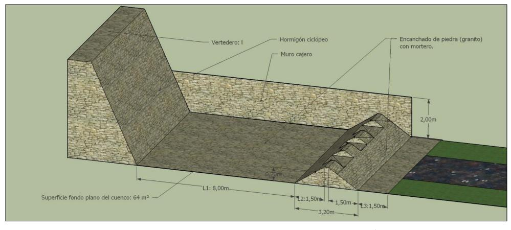
Figura 7. Croquis en 3D del cuenco amortiguador con contradique dentado y uno de los muros cajeros en un lateral. Fuente: Elaboración propia.
