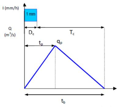
Figura 44. Esquema Hidrograma Unitario Triangular. Fuente: DIEZ (2014).
