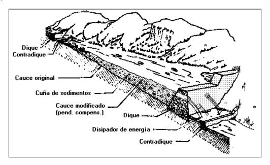
Figura 8. Esquema general del funcionamiento de dos diques forestales consecutivos con sus partes diferenciadas. Fuente: modificado de Suárez Villar (1993).
