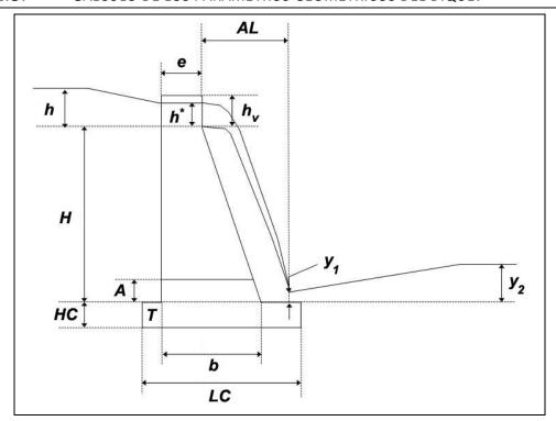
Figura 3. Elementos principales en el proceso de dimensionamiento de diques forestales. Fuente: DÍEZ (2012).
