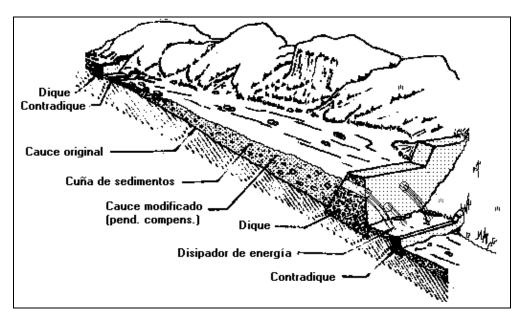
Figura 1. Esquema general del funcionamiento de dos diques forestales consecutivos con sus partes diferenciadas. Fuente: DÍEZ (2012).
