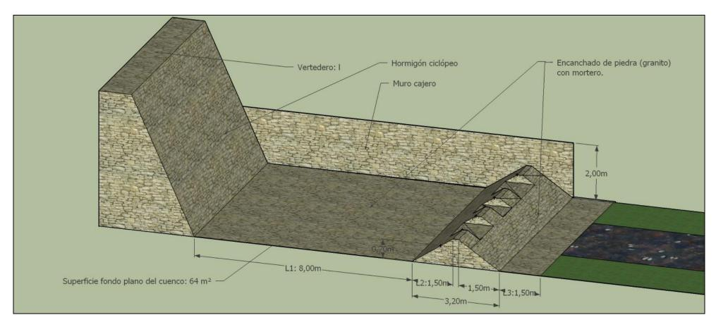
Figura 10. Croquis en 3D del cuenco amortiguador con contradique dentado y uno de los muros cajeros en un lateral. Fuente: Elaboración propia.
