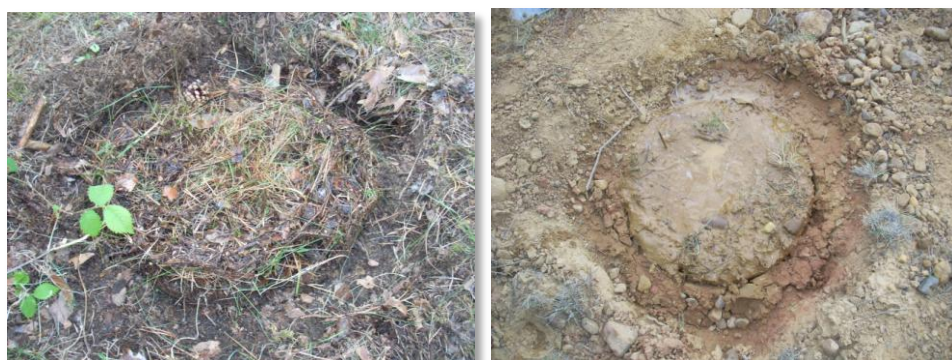
Figura 5.22. Detalle de la zona en la que se ha realizado el ensayo de infiltración tras retirar el cilindro, en un ensayo en la zona de bosque de pino (izquierda) y en la degradada de la cárcava restaurada (derecha).
