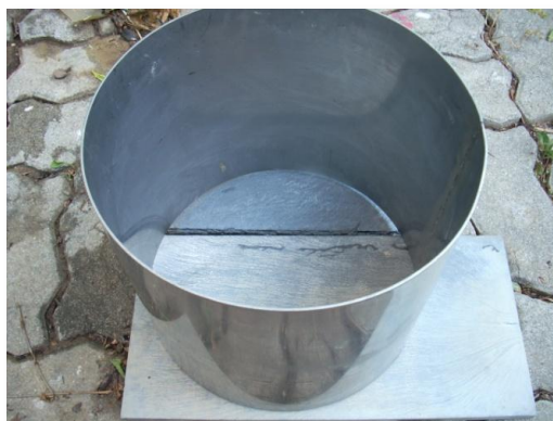
Figura 5.1. Infiltrómetro de acero.
