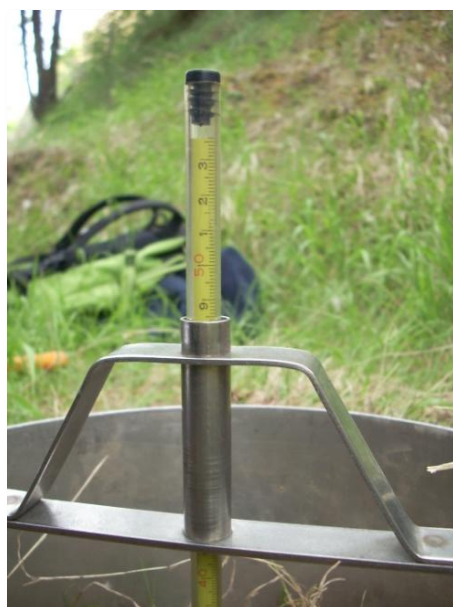
Figura 5.21. Detalle del flotador colocado en el puente.
