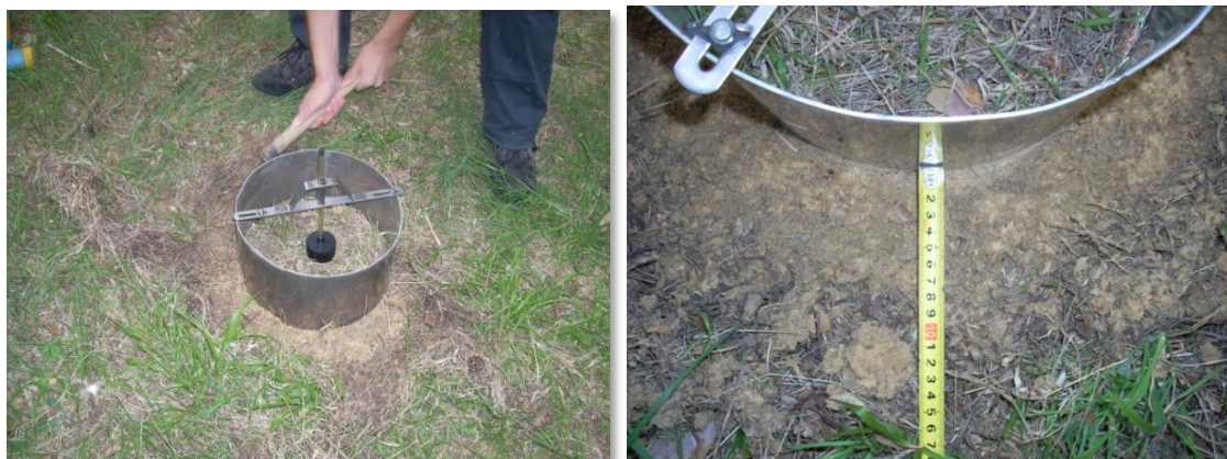
Figura 5.19. Zanja alrededor del cilindro.
