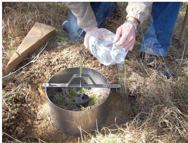
Figura 5.20. Humectación de la zona contigua al cilindro.
