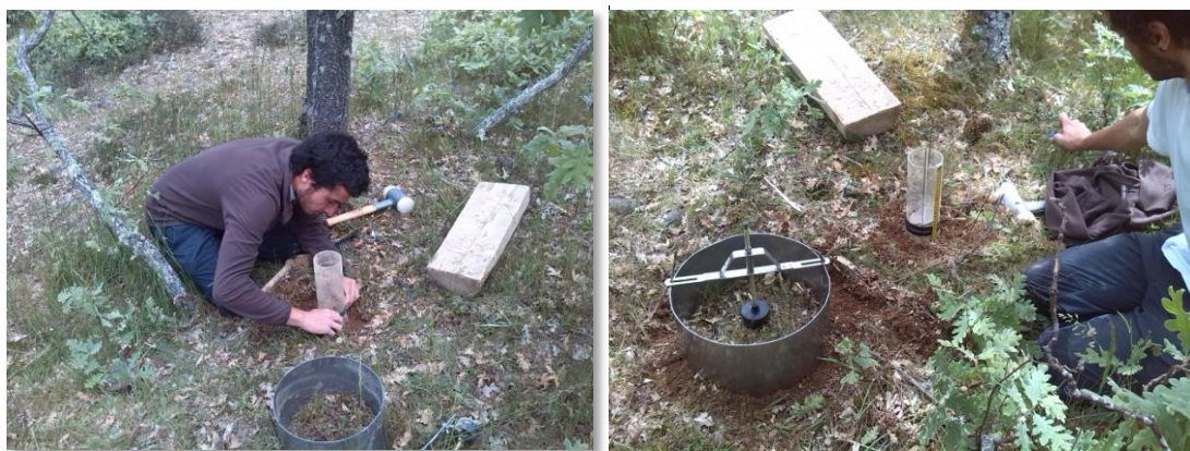
Figura 5.13. Colocación de los infiltrómetros para la realización de un ensayo de infiltración en la zona de robledal.
