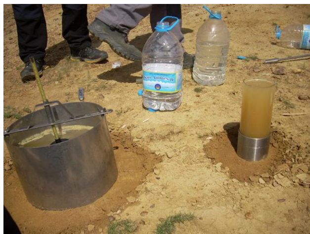
Figura 5.15. Detalle de colocación de los infiltrómetros por pares en el terreno de la cárcava natural.
