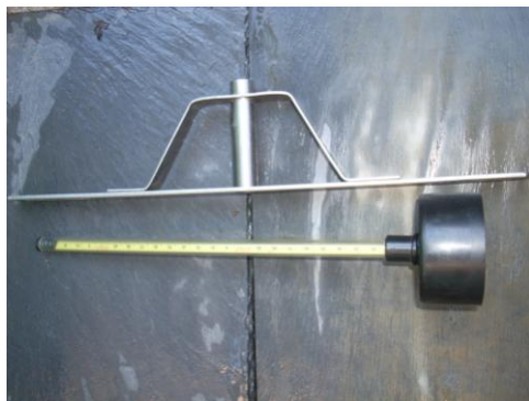
Figura 5.3. Flotador y puente.
