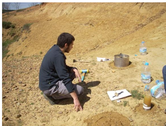
Figura 5.14. Realización de un ensayo de infiltración en la zona degradada de la cárcava natural.
