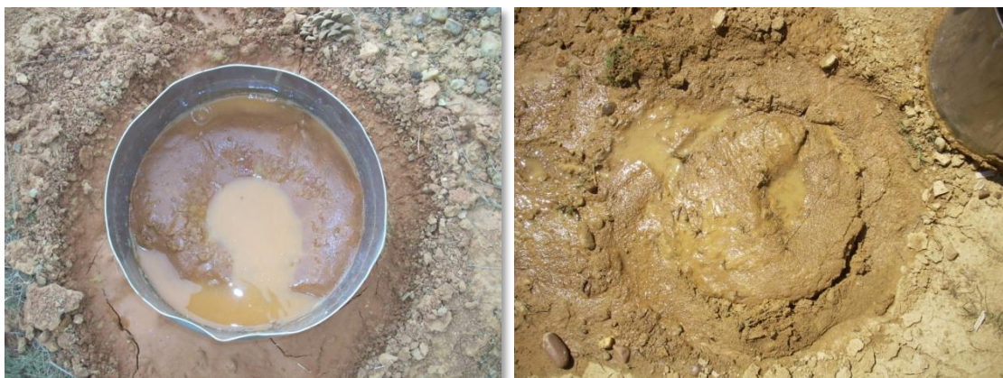
Figura 6.69. Imágenes donde se observa el gran contenido en arcilla de los suelos de la zona degradada, (izquierda: Zona degradada de la cárcava restaurada; Derecha: Zona degradada de la cárcava natural) hinchadas por el agua tras la realización de un ensayo con el infiltrómetro de 30 cm.
