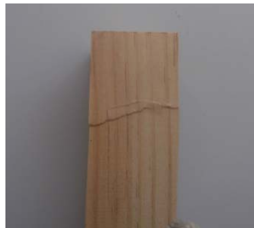
Figura 4.9. Detalle de rotura de probeta según norma UNE
