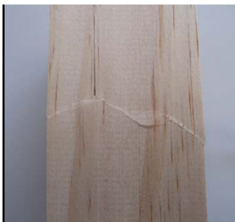
Figura 4.10. Detalle de rotura de probeta según norma ASTM
