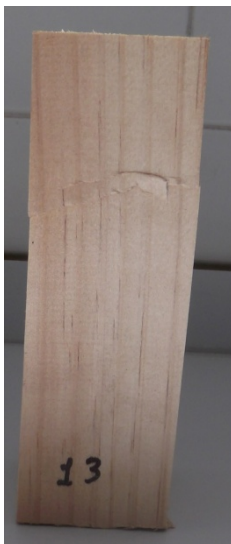
Figura 4.8. Detalle de rotura de probeta según norma ASTM
