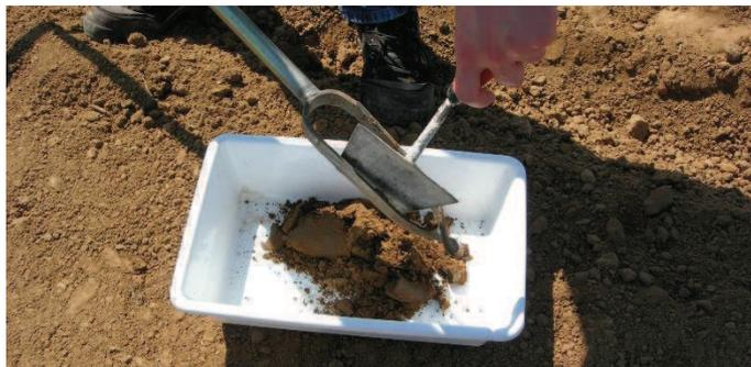
Figura 8: Recogida de muestras de suelo. Se observa el material utilizado.
