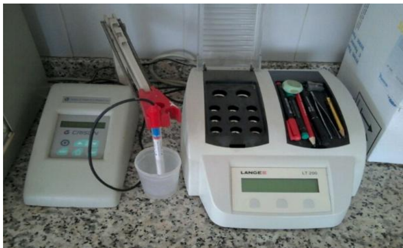
Foto 6. Izda: Conductímetro y sonda (roja). Derecha: calentador de muestras de bajo rango.
