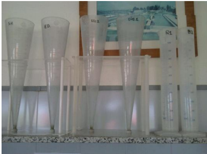
Foto 5. Conos Imhoff de 1L para SH, ED, D1 y D2. Derecha: probetas de 1L para R1-R2 y B1-B2
