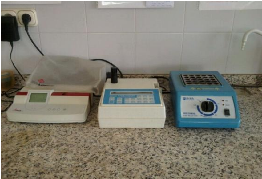
Foto 1. Izda: espectrofotómetro de rango bajo (0- 150mgDQO/L); Centro: espectrofotómetro de rango medio (150-1650mgDQO/L); Derecha: calentador de muestras de rango medio con temporizador.
