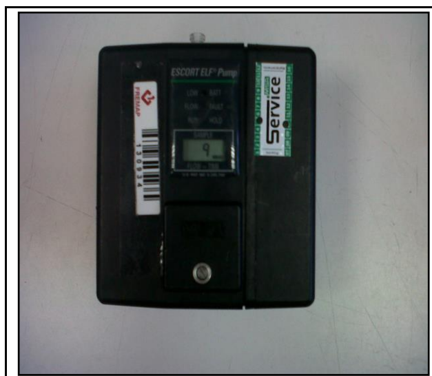
Imagen 2. Bomba de alto caudal
