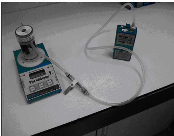
Imagen 4. Bomba de bajo caudal
