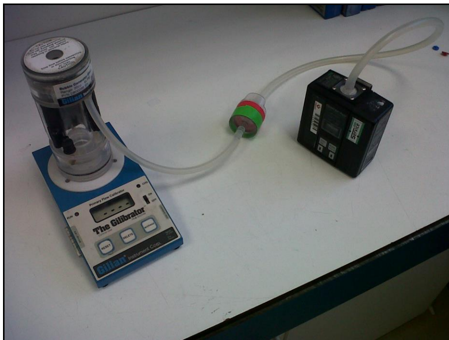
Imagen 6. Bomba de alto caudal
