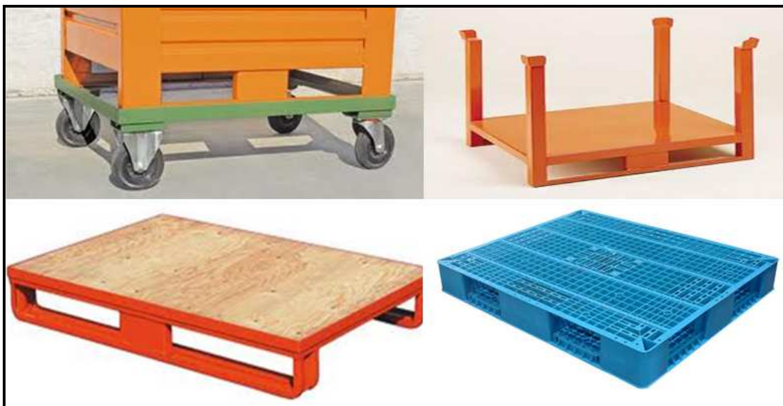
Figura 49. Diferentes plataformas para elevar el palet del componente 2 del puesto de carcasas de la línea B58 manual.
