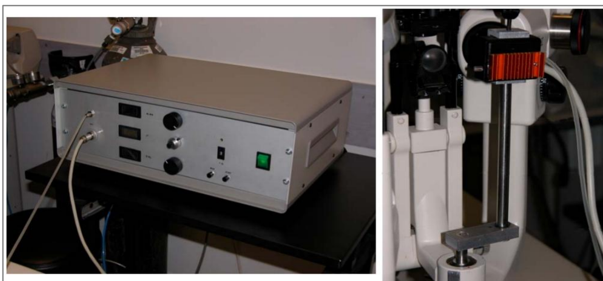
Imagen 2: Se muestra la unidad central del estesiómetro de gas (imagen de la izquierda) que se encuentra conectado al cabezal que lanza el estímulo de aire (imagen de la derecha). Este modelo se encuentra en el Instituto de Oftalmología Aplicada (IOBA).
