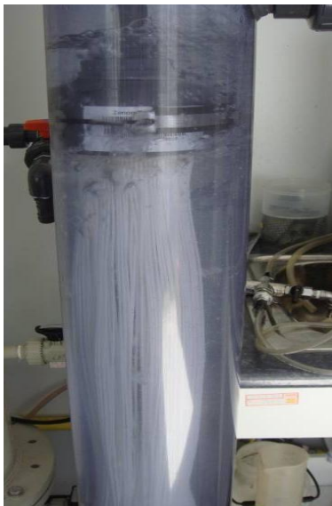
Figura 9.- Módulo de membrana ZW-10, con inyección de aire.
