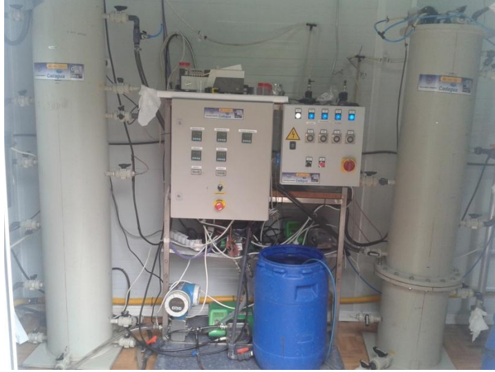
Fig. 5.- Foto de la configuración de reactores en serie
