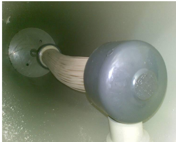
Fig. 6.- Módulo de membrana y membrana colgada de la parte superior del reactor
