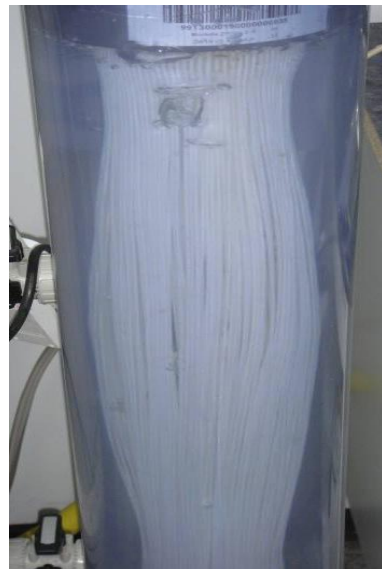
Figura 9.- Módulo de membrana ZW-10, con inyección de aire.
