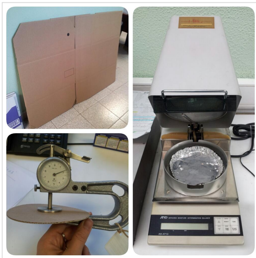
Foto 20. Caja antes de cortar, calibrador de reloj y báscula
