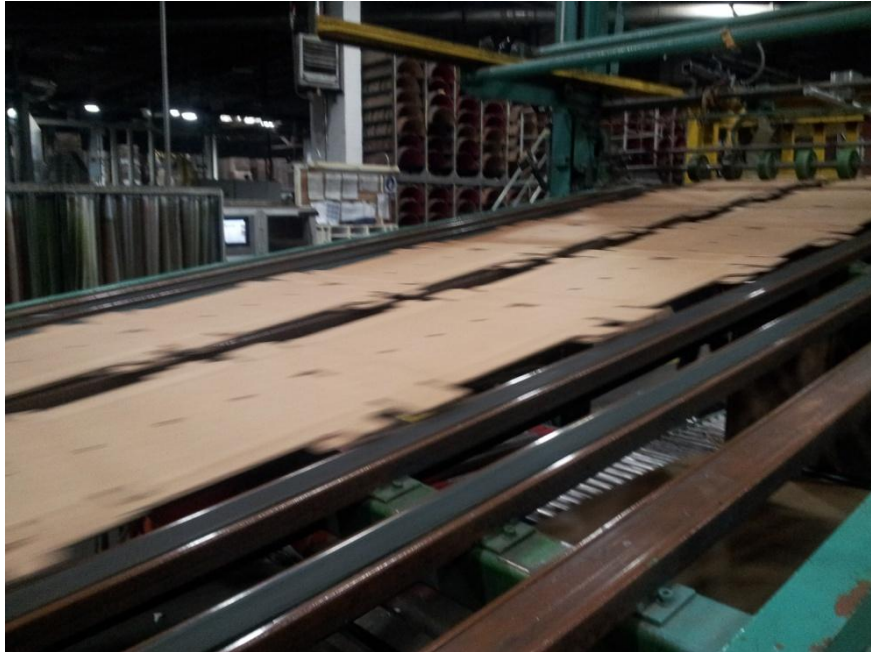
Foto 12. Cajas troqueladas saliendo de la máquina.
