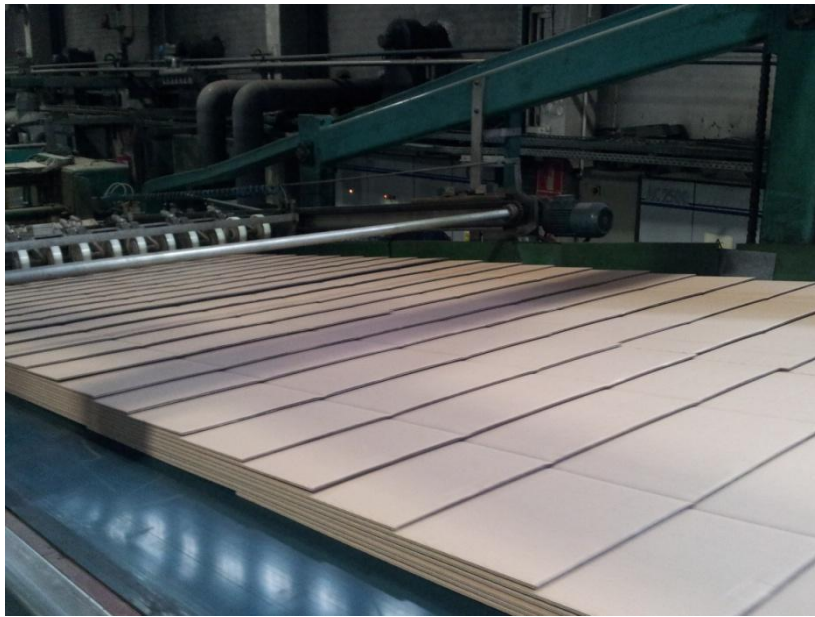
Foto 11. Planchas saliendo de la onduladora
