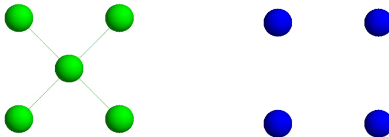
Fig. 4.1: Generación de vacantes en Ge cristalino. (Átomo de color verde: coordinación 4, átomo de color azul: coordinación 3).
