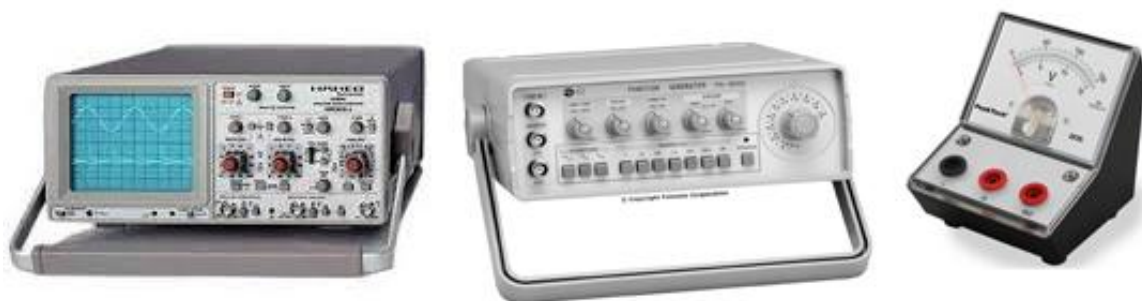
Figura 4 - Equipos de instrumentación físicos. De izquierda a derecha: osciloscopio, generador de funciones y voltímetro
