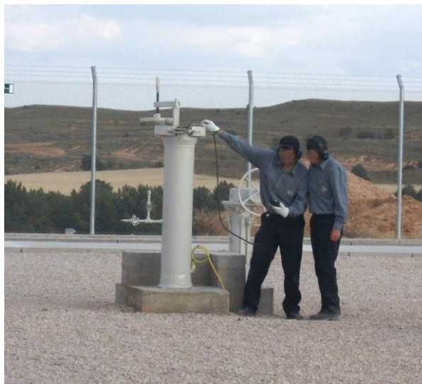
Imagen 6: comprobación con explosímetro
