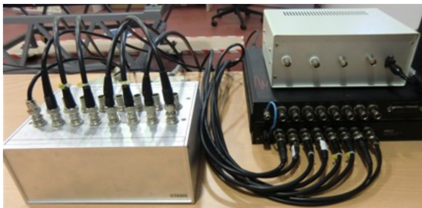
Figura 5.24 – Conexión entre WBK10 y amplificador de señal
