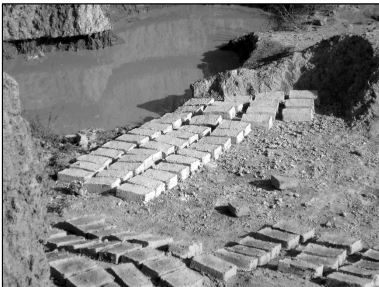
Fig. 5.– Fábrica de producción de adobes a las afueras de Ouagadou (Burkina Fasso)
