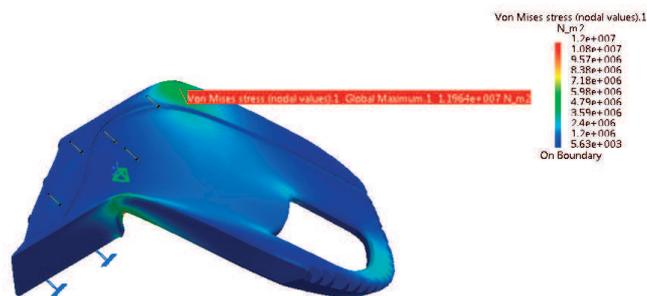
18) Tensión de Von Mises de la tabla ante condiciones de máxima carga.
