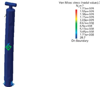
16) Tensión de Von Mises sobre el eje ante una carga puntual.
