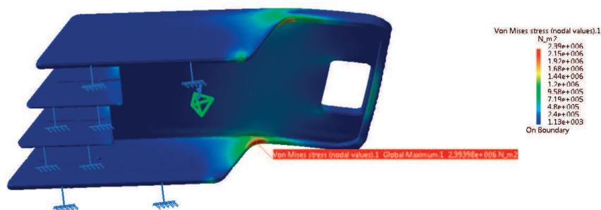
24) Detalle de tensión de Von Mises de la tabla ante una caída boca-abajo.
